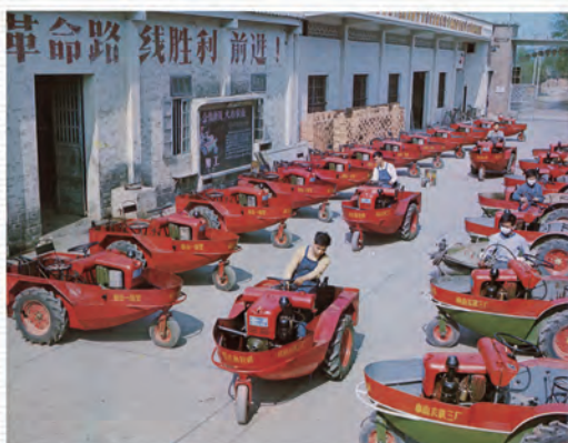
适用于水网地带耕作的“中山-10”型船式拖拉机。图片来源：《中山新貌》。
