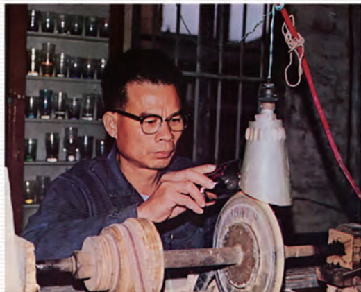
石岐玻璃厂技工正在玻璃制品上车花。图片来源：《中山新貌》
